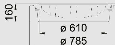
Rahmen: **Guss** DIN EN 124-2 | Deckel: **Guss** DIN EN 124-2, DIN 1229 | PG 1
