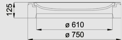
Rahmen: **Beton-Guss** DIN EN 124-2 | Deckel: **Einlaufgitter** DIN EN 124-2 | PG 1
