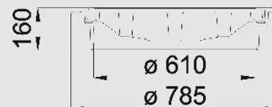
Rahmen: **Guss** DIN EN 124-2 | Deckel: **Guss** DIN EN 124-2, DIN 1229 | PG 3
