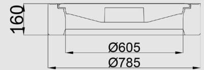
Rahmen: **Guss** DIN EN 124-2 | Deckel: **Einlaufgitter** DIN EN 124-2 | PG 3
